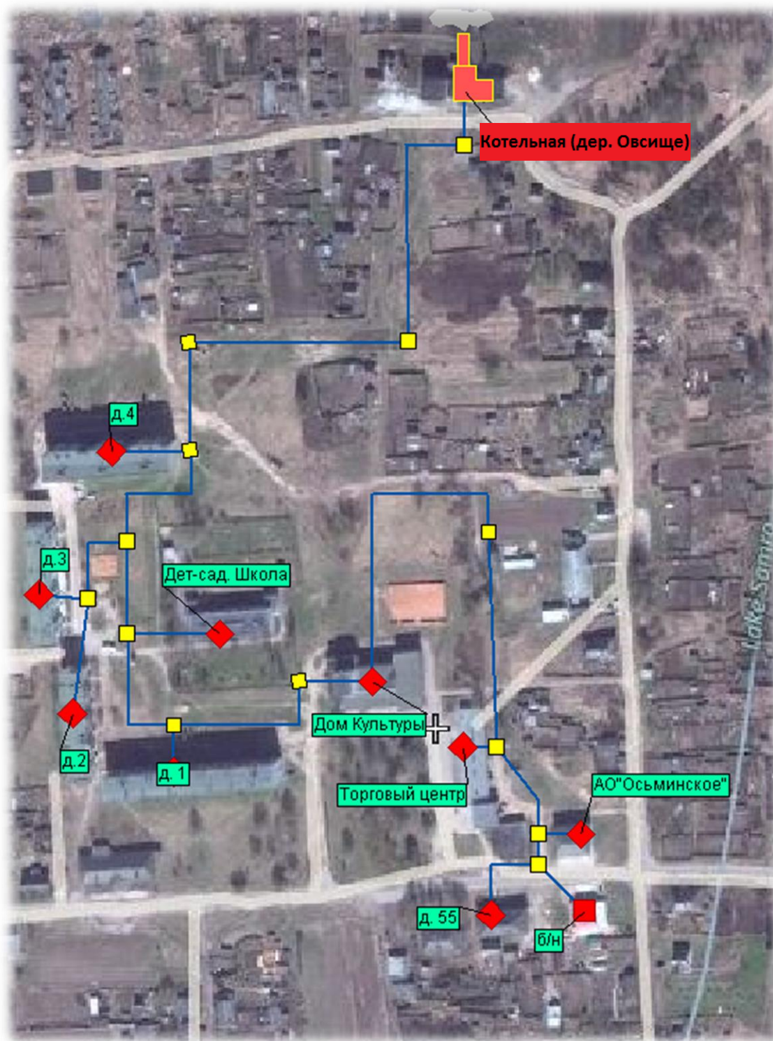
Рисунок 6. Схема тепловых сетей от котельной (дер. Овсище).
