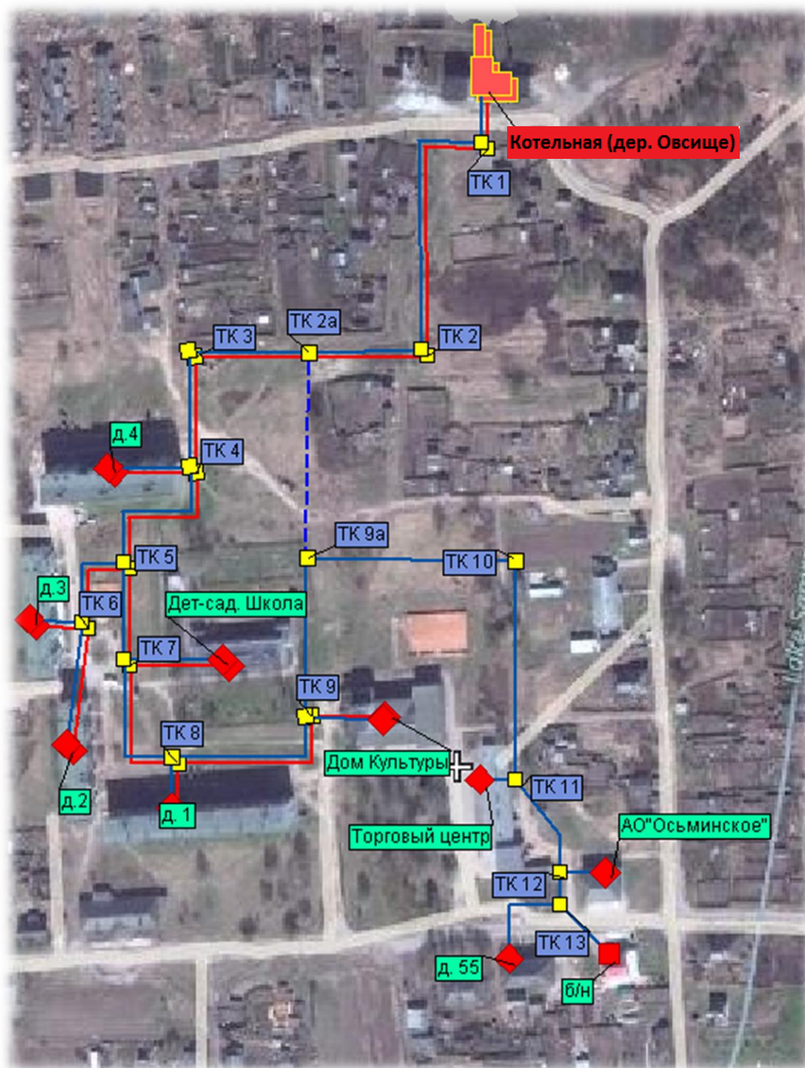
Рисунок 19. Схема горячего водоснабжения от котельной (дер. Овсище).
