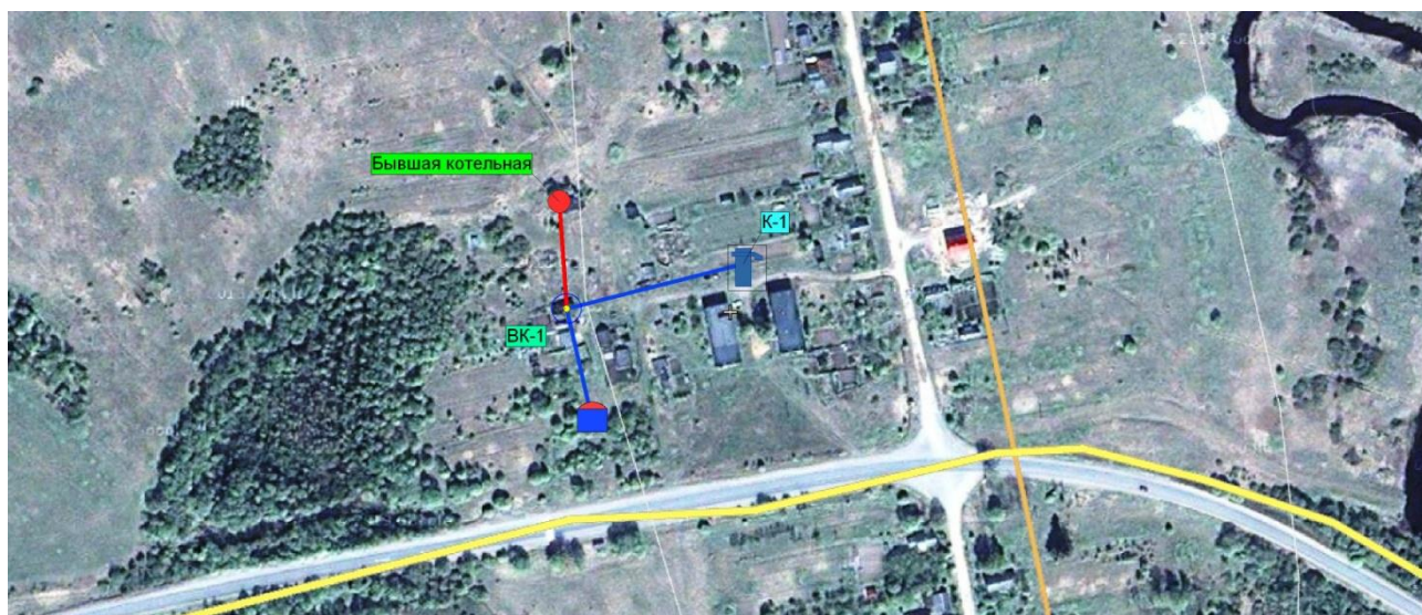
Рисунок 17 - Схема сети водоснабжения (Колодриво)
