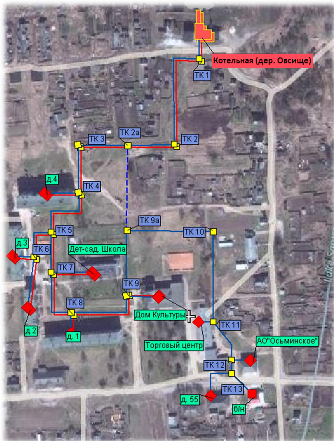
Рисунок 5. Схема горячего водоснабжения от котельной (дер. Овсище).
